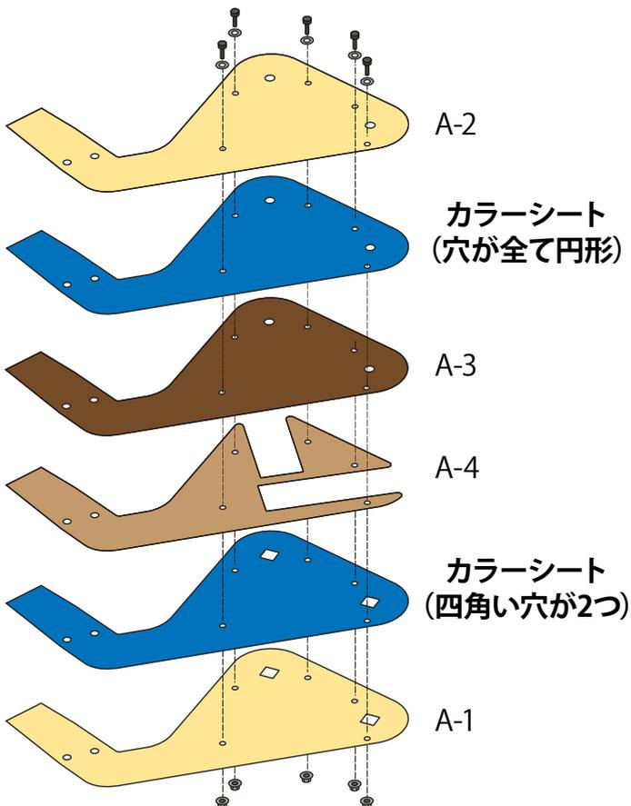
「05/バットプレートの組み立て」を行う時に、D-2とD-1の間にカラーシートを挟んで下さい。
