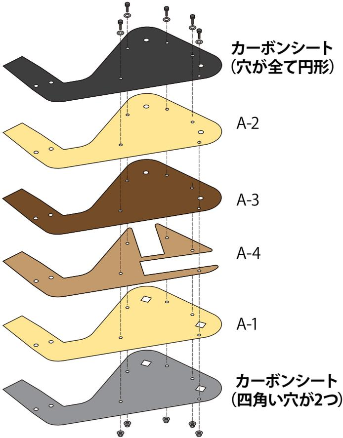
「05/バットプレートの組み立て」を行う前に、D-2に付属のカーボンシートを貼り付けてください。組み立てた時に、カーボンシートを貼った面が外側に来るようにしてください。
